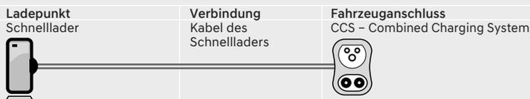
Der IONIQ 6 kann an einem Gleichstrom-Schnelllader (DC) mit bis zu 220 kW Leistung geladen werden. Die Ladegeschwindigkeit ist zu Beginn am höchsten und nimmt dann allmählich ab. Ein Aufladen der Batterie auf über 80% ist also möglich, aus Zeit- und Kostengründen jedoch nicht mehr optimal. Sollen über kurze Zeit lange Distanzen zurückgelegt werden, ist es oftmals effizienter, den Ladevorgang bei maximal 80% Ladezustand zu stoppen.
