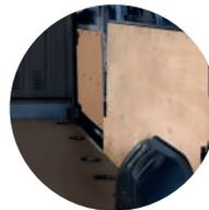
**Laderaumschutz:** Massgeschneiderte halb- oder vollflächige Seitenpaneele aus Holz sowie ein harzbeschichteter Boden schützen den Laderaum vor Beschädigung.
